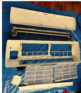
Filtros de aire después del mantenimiento
