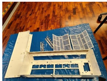
Accesorios de la unidad evaporadora después del mantenimiento
