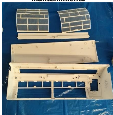
Filtros de la unidad evaporadora después del mantenimiento
