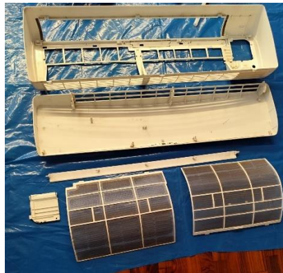
Filtros de aire durante el mantenimiento
